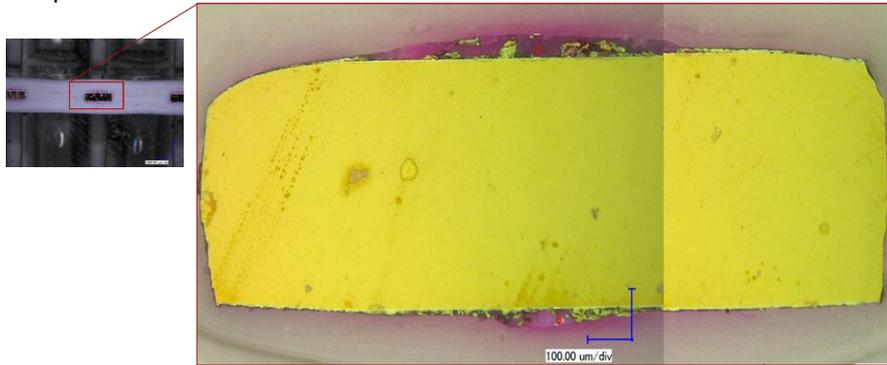
Schliffbild an Stanzgitterdemonstrator. Spalthöhe 33 µm bzw. 44µm. Spalte <<10µm ebenfalls typisch. Violetter Schimmer: „Crack-Knacker“
